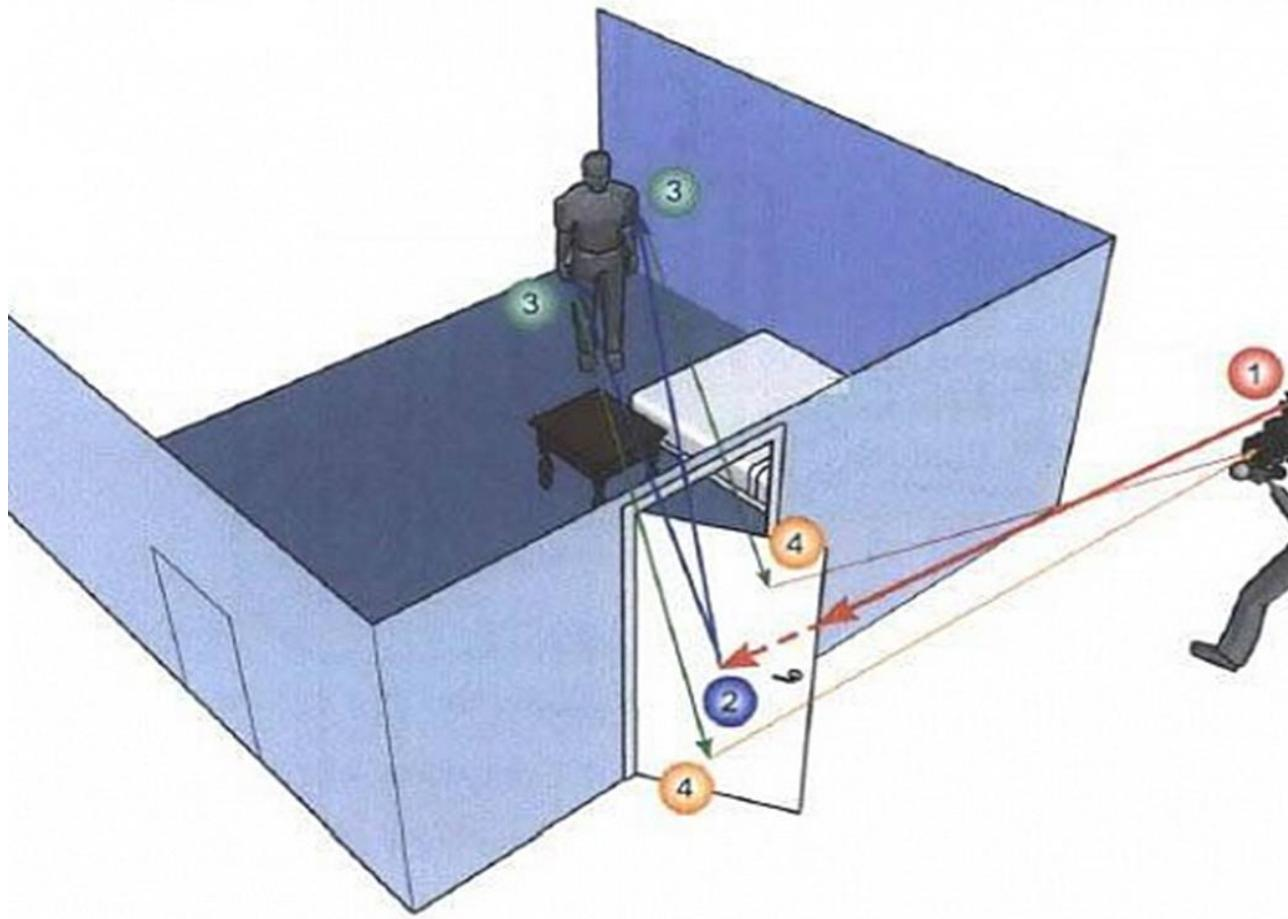
Новая технология позволяет цифровому фотоаппарату или видеокамере снимать даже то, что находится за углом и оператору не видно.
