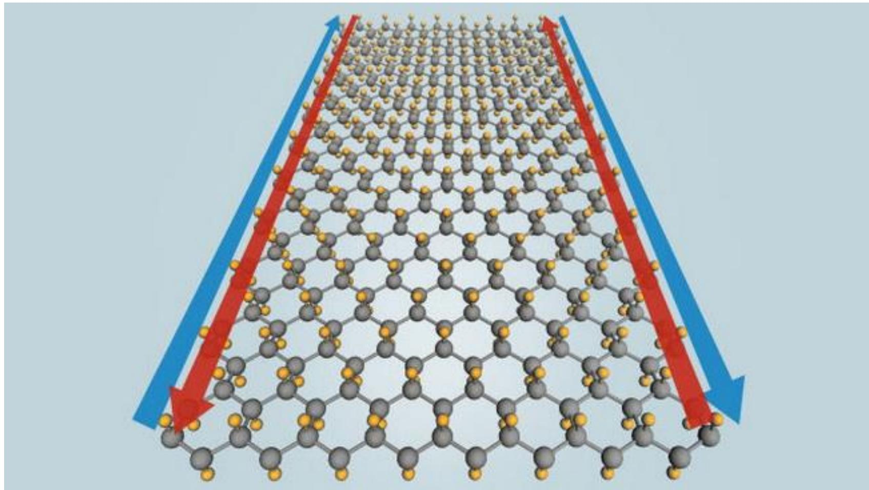
Впервые «станен» был описан в 2013 году стэнфордским ученым Су Чон Чаном, чья лаборатория специализируется, помимо прочих вещей, на предсказании свойств материалов. Согласно их модели, станен является диэлектриком (изолятором), а электрический ток он проводит снаружи.
