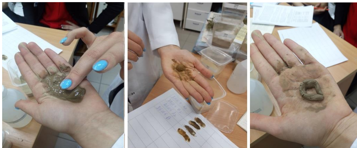
Рисунок 4. Определения гранулометрического состава методом скатывания шнура
