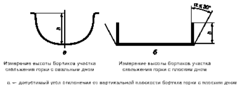
Рисунок А.2 — Измерение высоты бортиков участка скольжения горки
