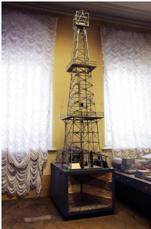
Модель действующая «Роторная буровая установка». М. 1:10. СССР, 1930 г. На прямоугольномвысоком сером коробчатом основании с имитацией разреза горных пород установлена серая металлическая буровая каркасная вышка на 4 опорах.
