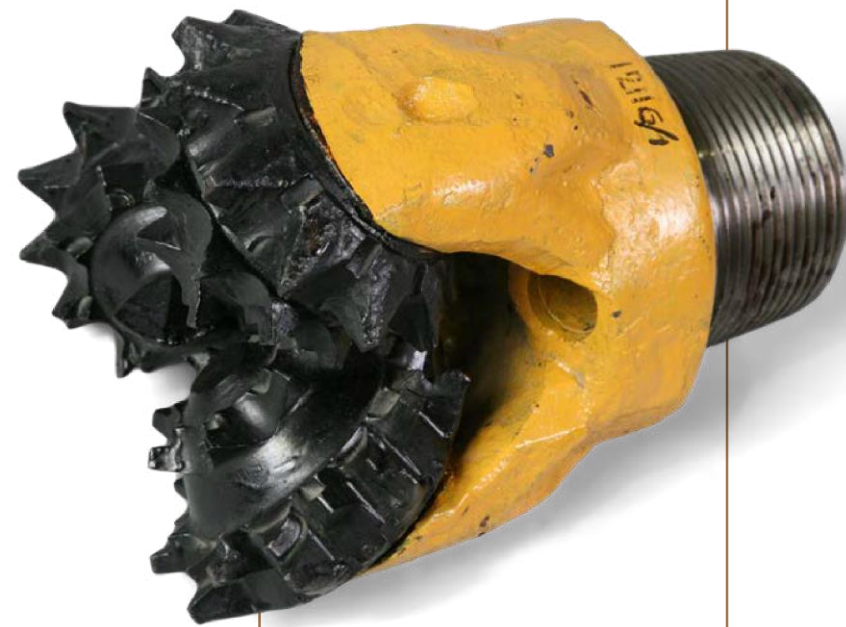
Долото буровое трехшарошечное гидромониторное 5Н243МГ для сплошного бурения мягких породах. СССР, г. Москва. 235x235x325 мм КП 12116/1 Политехнический музей
